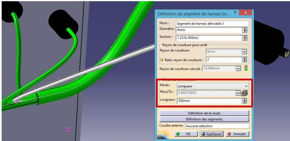
4. Remettre le connecteur en position fonctionnement la longueur est bloquée
