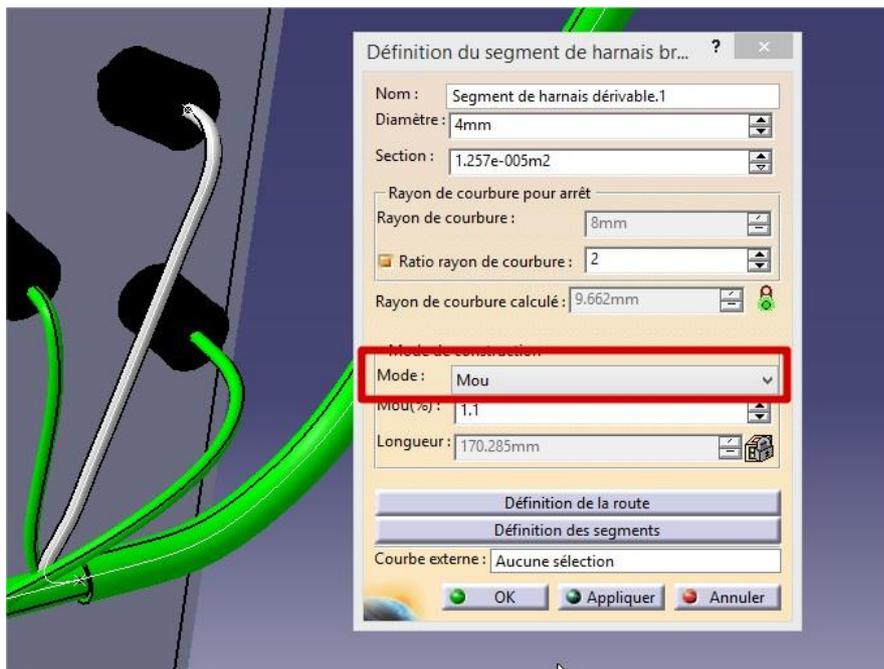
2. Positionner en position test, la longueur du segment de harnais se recalcule en mode Mou
